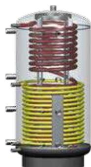
Depósitos de inercia con producción instantánea de ACS en INOX corrugado, con serpentín de intercambio para solar y estratificación. Aislamiento de 100 mm de espesor.
